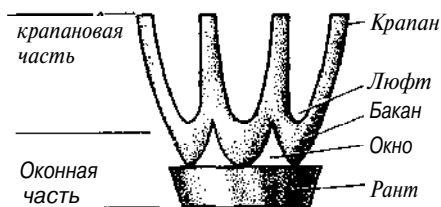
Рис. 85. Элементы крапанового каста
