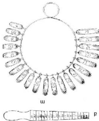
Նկար 19. Մատի և մատանու չափման գործիքներ՝ ա) մատնաչափ, բ) օղաչափ
