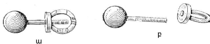
Նկար 52. Պտուտակների վրա ամրացվող ականջօղեր՝ ա) հավաքված վիճակում, բ) քանդված վիճակում
